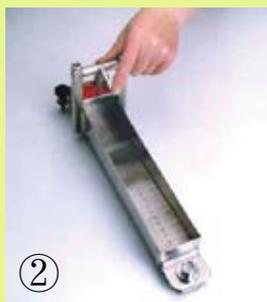
按动弹簧门上的锁扣使弹簧门瞬间弹起，同时用一个秒表开始计时
