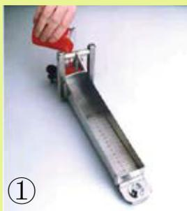
将待测的样品（通常是75ml倒入弹簧门后的样品槽；）
